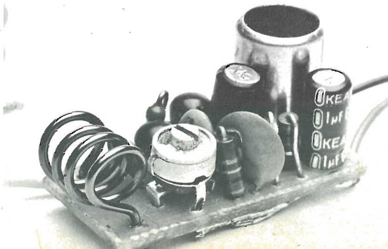
*Nelle immagini le due versioni del microtrasmettitore: in alto il circuito previsto per essere alimentato con batterie a pastiglia, in basso il modello che preleva tensione da una comune pila da 9 volt per transistor. Nella pagina accanto gli elementi costitutivi della scatola di montaggio.*
