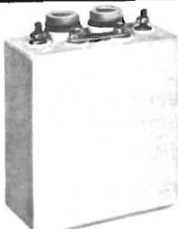
**NICHEL-CADMIO** a liquido alcalino, 2 elementi da 2,4 V 6 A/h in contenitore plastico. Ingombro 79x49x100 m/m. Peso kg. 0,63. Durata illimitata, non soffre nel caso di scarica completa, può sopportare per brevi periodi il c.c. Ideale per antifurti, lampade di emergenza, inverter, ecc. Può scaricare (per esempio): 0,6 A per 10 h oppure 1,2 A per 5 h oppure 3 A per 1,5 h ecc. La batteria viene fornita con soluzione alcaline in apposito contenitore.
