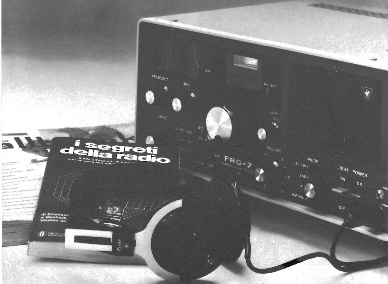
Il modello FRG-7 è un ricevitore sintetizzato, a stato solido in grado di coprire l'intera gamma delle alte frequenze, da 500 KHz a 29,9 MHz.
