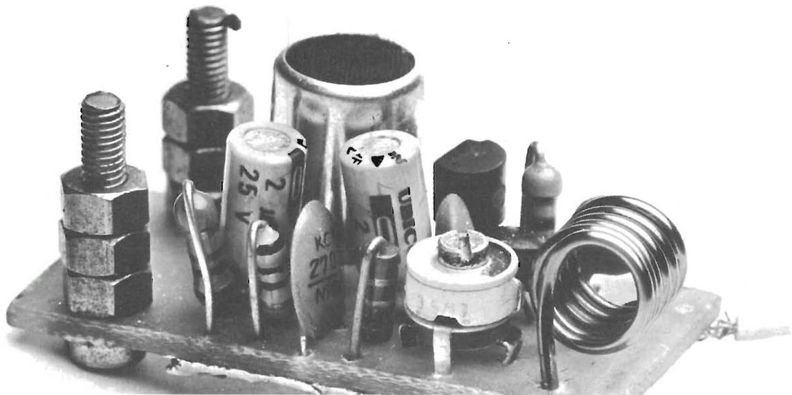
tore esso capterà e irraderà i rumori e le voci provenienti da tutte le stanze. Per poter funzionare il preamplificatore contenuto all'interno del minuscolo microfono deve essere alimentato; per questo motivo il microfono dispone di un terzo terminale che deve essere collegato alla linea positiva di alimentazione.
