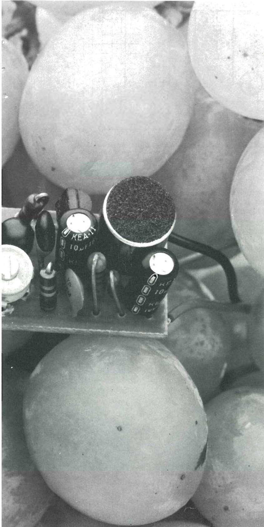
Due differenti modi per realizzare piccolissimi trasmettitori per la gamma della modulazione di frequenza. Solo due transistor ed un microfono a fet per ottenere un chiaro e nitido segnale per tutte le radio FM.
